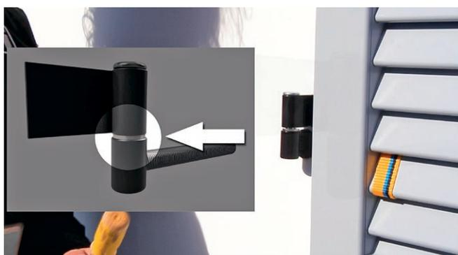
6 - Montare la pipa con la relativa rondella copriforo e boccola di spessore tra pipa e bandella. Centrare l'asse della bandella e l'asse della pipa con l'apposito perno e accertarsi che la pipa sia perfettamente aderente alla base della boccola.
